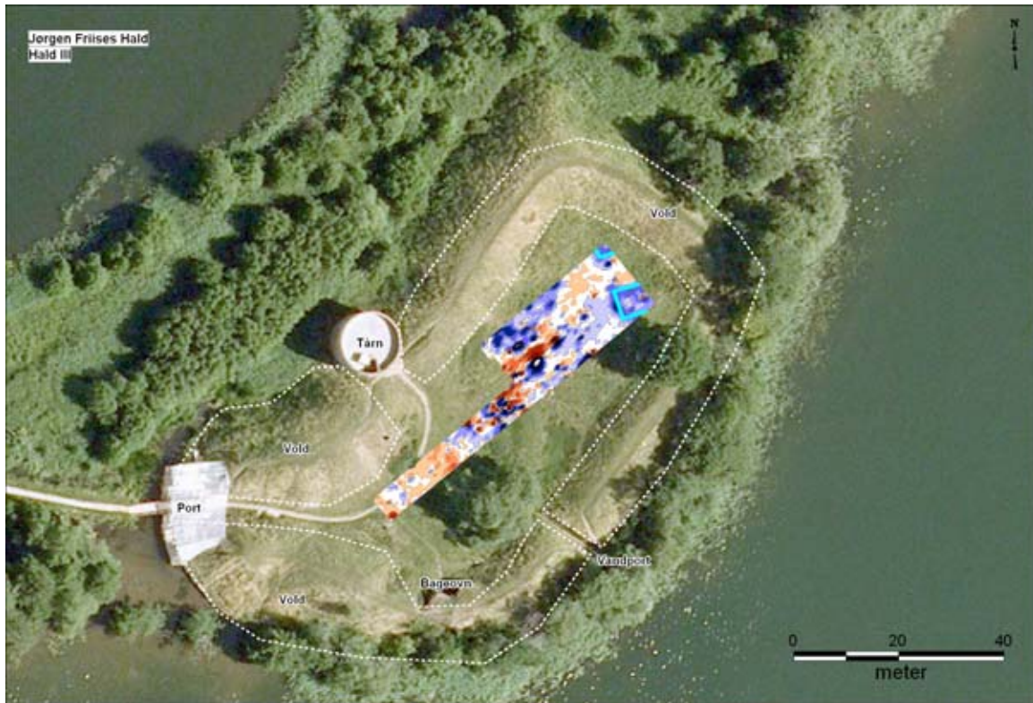
Figur 44. Georefereret magnetometermåling på Hald III. Tatiana Smekalovas forslag til mulige vægforløb fra bygninger er markeret med lyseblå streger. Baggrundskort er luftfoto fra 2008. Her ses portområdet overdækket i forbindelse med de sidste års restaureringsarbejder på borgen.
