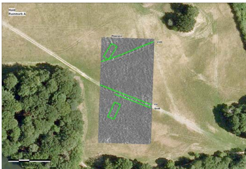
Figur 70. Georefereret georadarmåling på Ruinmark A (sydvest for Hald I). FalkGeos forslag til pløjespor, vold, vej og grøft samt huse i 0,30 m's dybde. Baggrundskort er luftfoto fra 2008. Der ses et tydeligt sammenfald mellem georadarmålingens vejforløb og det eksisterende forløb af markvejen.
