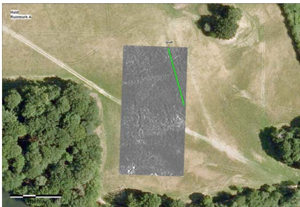
Figur 74. Georefereret georadarmåling på Ruinmark A (sydvest for Hald I). FalkGeos forslag til grøftforløb i 0,45 meters dybde. Baggrundskort er luftfoto fra 2008.
