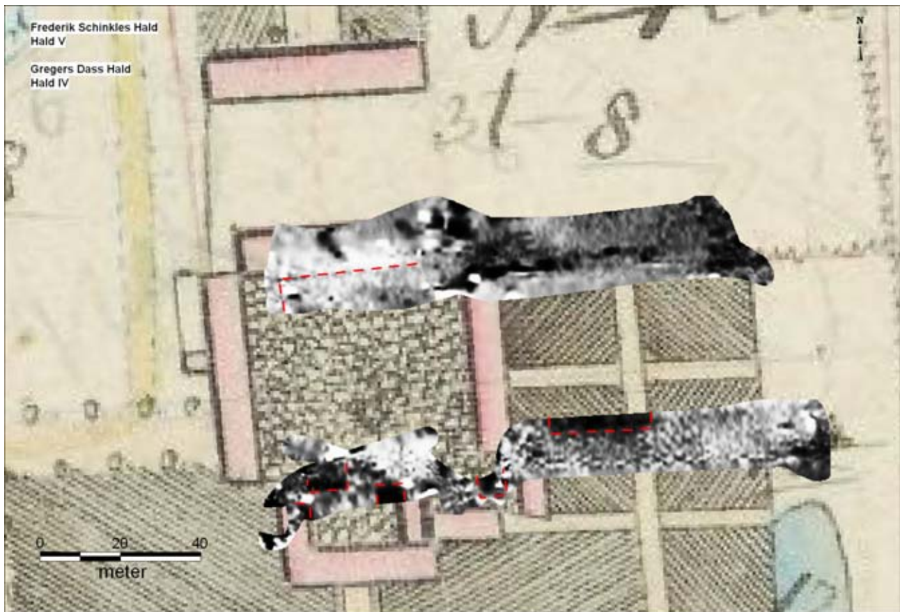
Figur 64. Georefereret udsnit af Original 1 kortet over Hald Hovedgård fra 1815 og den elektromagnetiske måling. Henover det georefererede Original 1 kort er med stiplede linje markeret anomalier udskift ved den elektromagnetiske måling. Ligesom ved georadarmålingen ses mod nord et forholdsvis tydeligt sammenfald mellem målingernes spor efter murforløb og sydfacaden af Gregers Daas øst-vest-orienterede, store bindingsværksbygning. Derudover ses ingen direkte sammenfald mellem Original 1 kortet og målingen. Dog ses nogen sammenfald i to tilfælde, nemlig ved de to nord-syd orienterede udløberfløje (nr. 2 og 3 på Figur 47) på nordsiden af den gamle hovedbygning mod syd. Muligvis er det disse to bygninger, som den elektromagnetiske måling har fundet spor efter.
