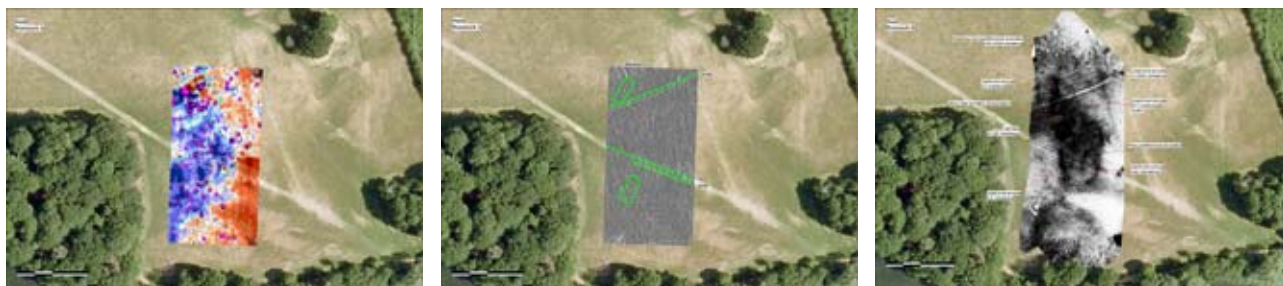
Figur 79. Magnetometermålingen til venstre, georadarmålingen i midten og den elektromagnetiske måling til højre.
